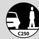
250Kn Test Load
