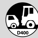
400Kn Test Load
