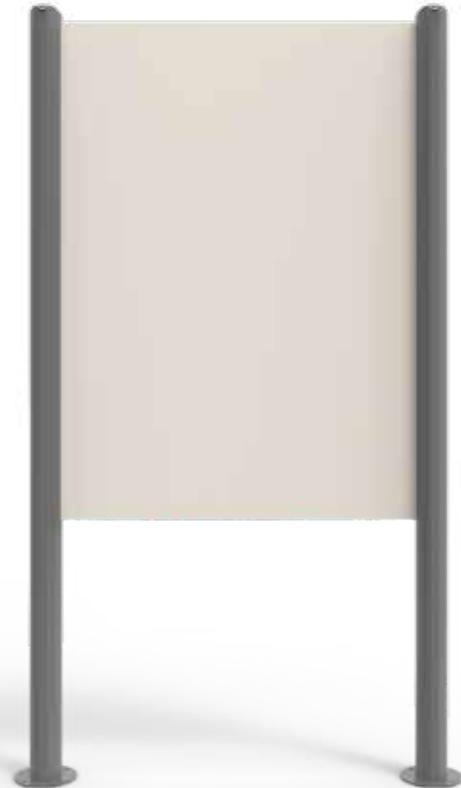
Tableau d'affichage composé de deux éléments verticaux en aluminium extrudé thermolaqué et d'une table à panneaux en tôle thermolaqué. La fixation est réalisée en noyant le noyau en acier au sol ou avec une plaque de base en acier.
