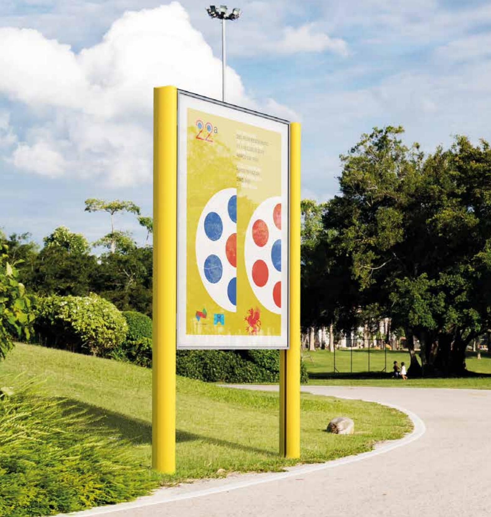
Espositore composto da due elementi verticali in estruso di alluminio verniciato e da una tabella in lamiera verniciata. Il fissaggio avviene annegando al suolo l'anima in acciaio oppure con piastra base in acciaio.
