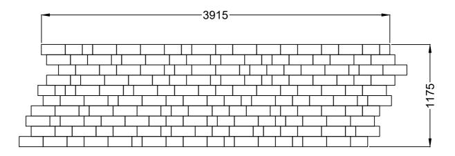
Suggested layout using: 355x155 mm module paving - 90no. 255x155mm module paving - 60no. 155x155mm module paving - 30no.
